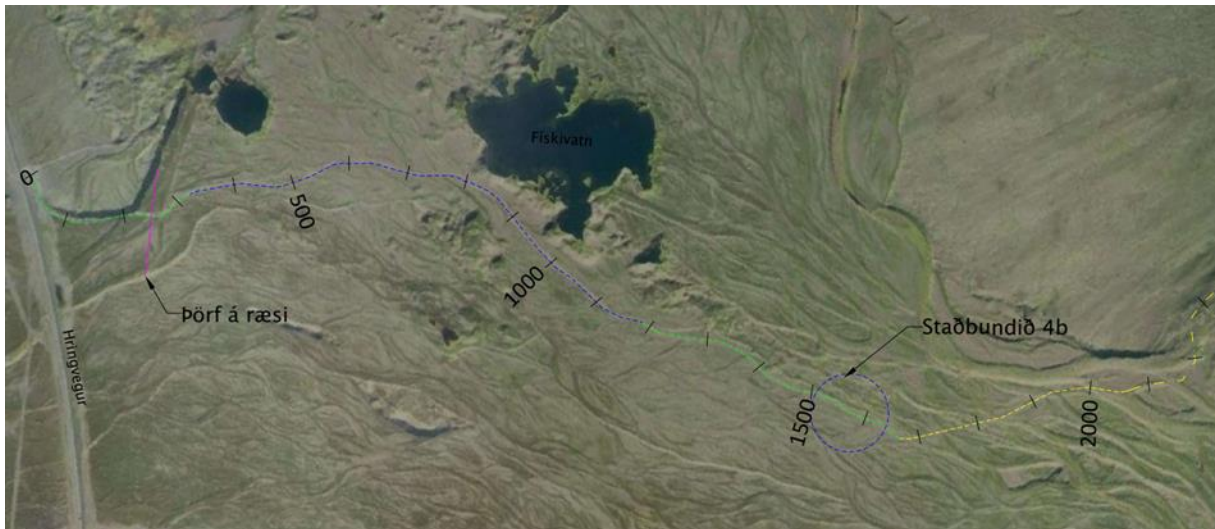
Mynd 61. Þröng, 0 – 2,2 km. Grænn litur er flokkur 3 (6-9 m), en blár flokkur 4, þar sem slóðin er breiðari en 9 m. Ástand slóðarinnar á þessum kafla er að mestu í flokki (b).
