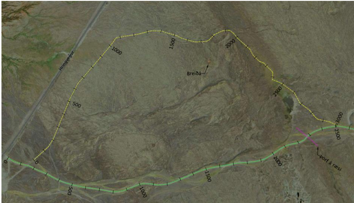
Mynd 81. Fyrsti hluti Námuvegarins (flokkur 3) í grænum lit, frá Hringveginum og inn fyrir jökulöldurnar, slóðin að bragganum Breiðá er ofar á myndinni sýnd með gulum lit (flokkur 2).
