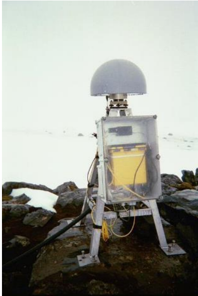
Mynd 61. GPS-mælistöð við sunnanverðan Mýrdalsjökul. Ljósmynd Halldór Geirsson, maí 2000. Myndasafn Veðurstofu Íslands.
